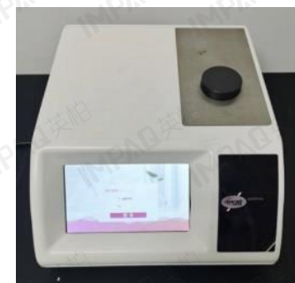
自动折光仪，用于折光指数的测定
