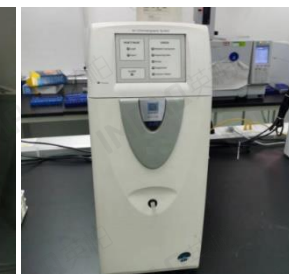
离子色谱仪，用于亚硝酸盐、氮等物质的测定。
