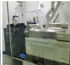
LC-MS/MS，用于亚硝胺、可提取&可溶出物、甜味剂等物质的分析
