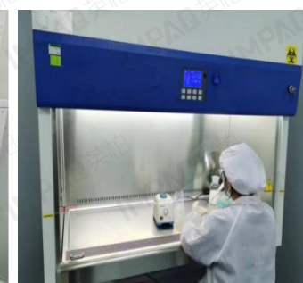
生物安全柜，用于菌种试验和带菌样品的无菌操作
