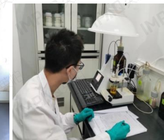
卡尔费休水分测试仪，用于水分的测定。
